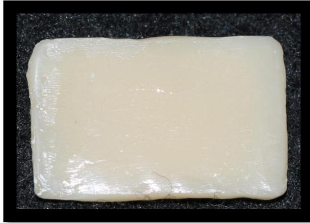
Figura 20. Cuerpo de prueba después del pulido
