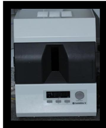
Figura6. Lámpara de fotopolimerización
