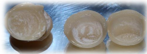
Imagen 18 y 19. Las Primeras coronas prensadas en el horno ProPress SP®, en los dos primeros prensados no se completaron, dicho horno debe estar bien calibrado para que el prensado sea exitoso.
