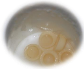
Imagen 13. Remoción de la capa de reacción formada durante el prensado con solución HF (IPS e.max Press® Invex liquid , Ivoclar Vivadent®) en un ultrasonido por 5 min.
