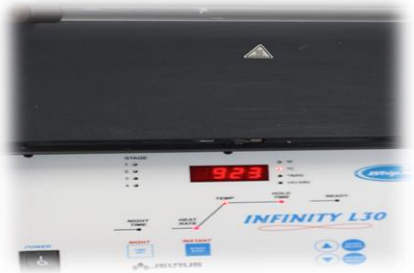
Imagen 10. Se llevó al horno de desencerado hasta completar el ciclo de cera perdida, en el horno de desencerado.
